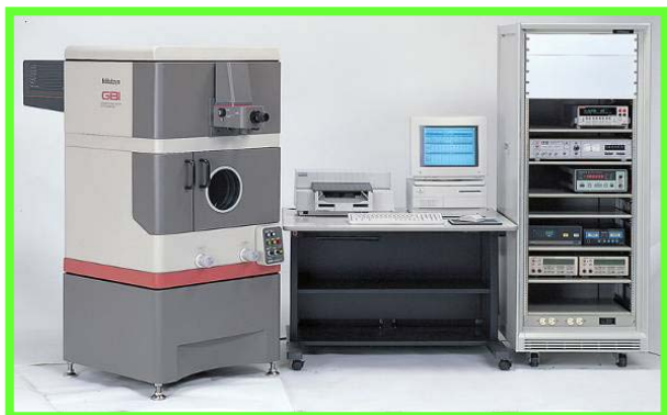
Figura 8. Interferómetro para calibración de bloques patrón (Planta de Mitutoyo en Miyazaki, Japón)
