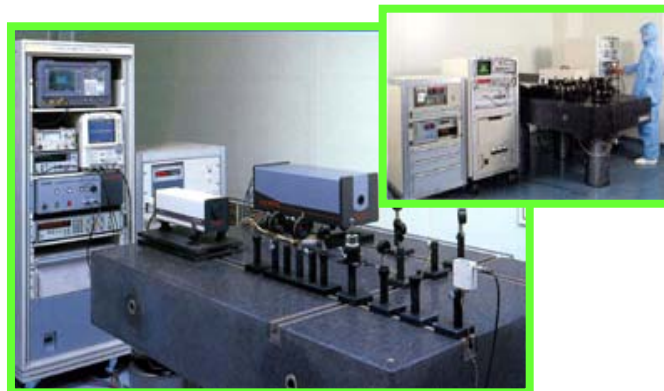
Figura 9. Sistema de calibración de láseres (laboratorio de Mitutoyo en Japón)
