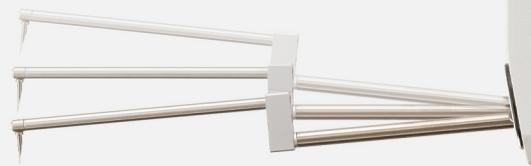
»» La escala rastrea directamente el arco del palpador para aplicar la compensación necesaria
